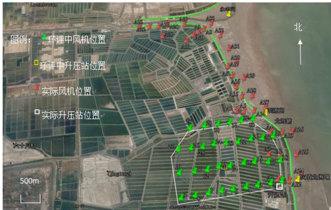
图1 风电场实际平面布置与环评中风电场平面布置对比
