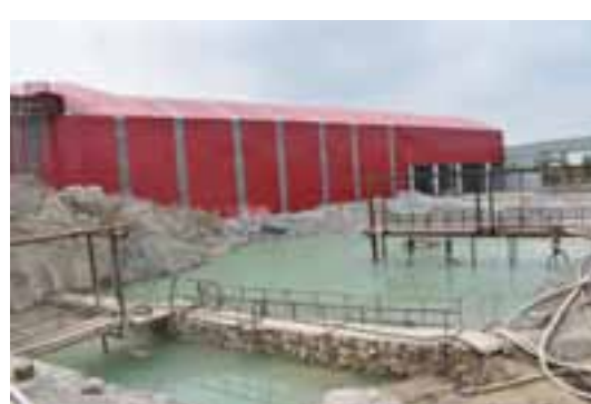
水洗砂废水经沉淀池沉淀后回用
